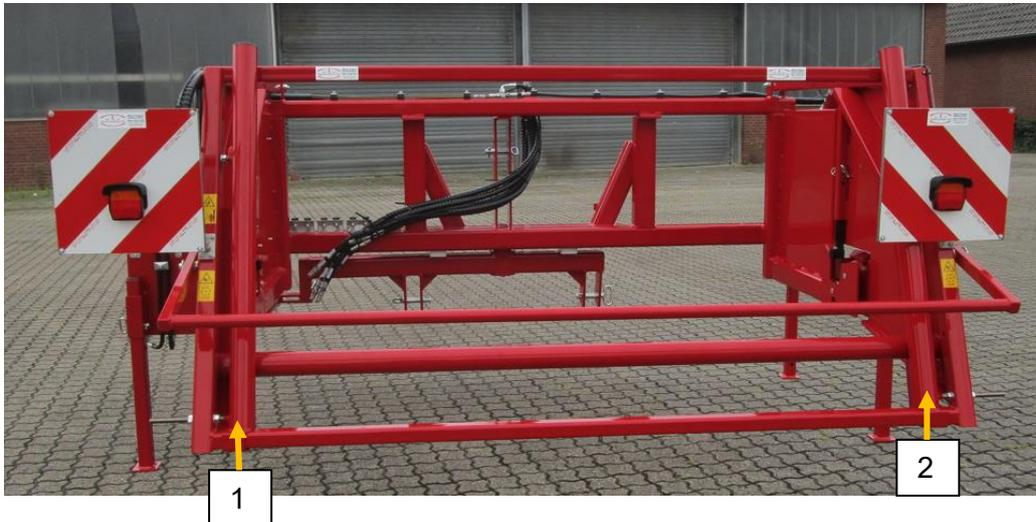
Die beiden Rohre lassen sich über die Schrauben rechts und links feststellen.
