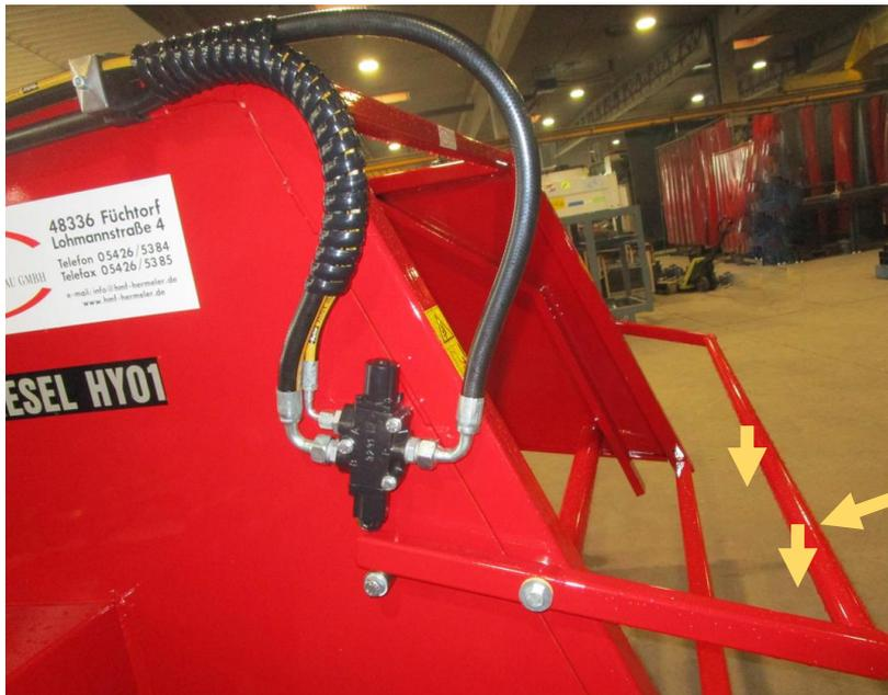
Der hintere Bügel (8) ist ein Not-Aus-Bügel und Abstandshalter. Wird der Bügel nach unten gedrückt, wird der Folienwickler automatisch zum Stillstand gebracht.
